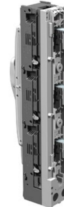
ZHBM 00/123-Ausführungen (mit 32,5 mm zusätzlicher Tiefe) erlaubt das rückseitige Aufstecken je eines Stromwandlers pro Phase.
